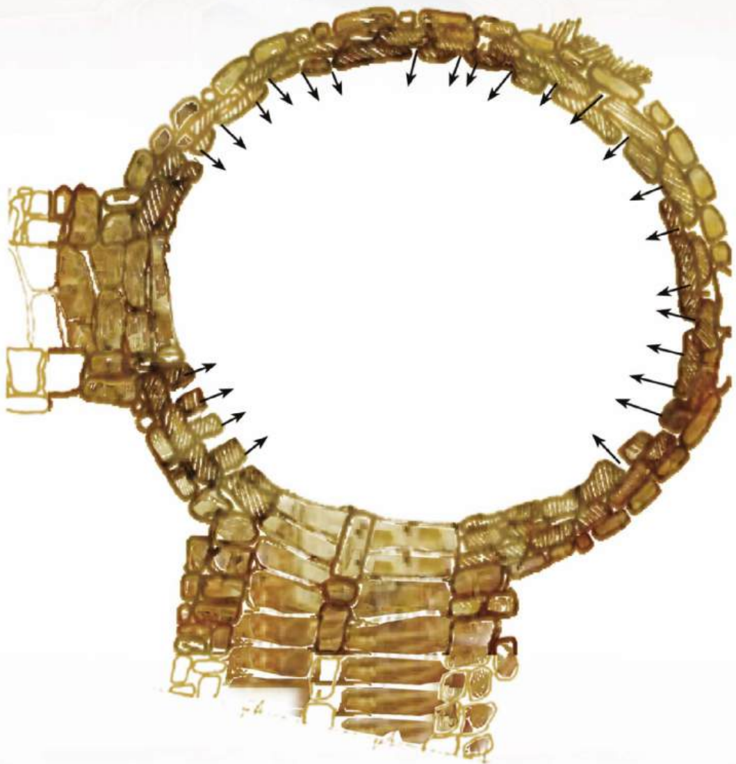
Schéma du puits de ZamZam montrant les directions des flux d'eau d'alimentation (modifié d'après Şen, 2008).
