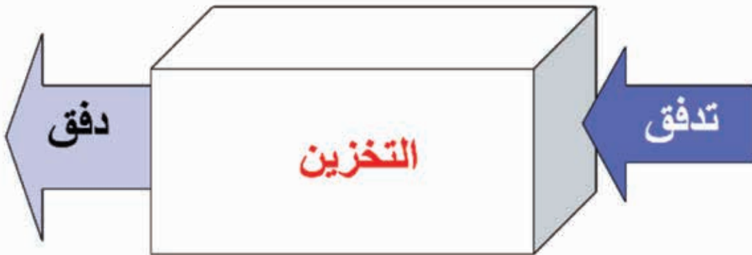
رسم توضيحي لمصطلح التخزين المستخدم في معادلة توازن الماء.
