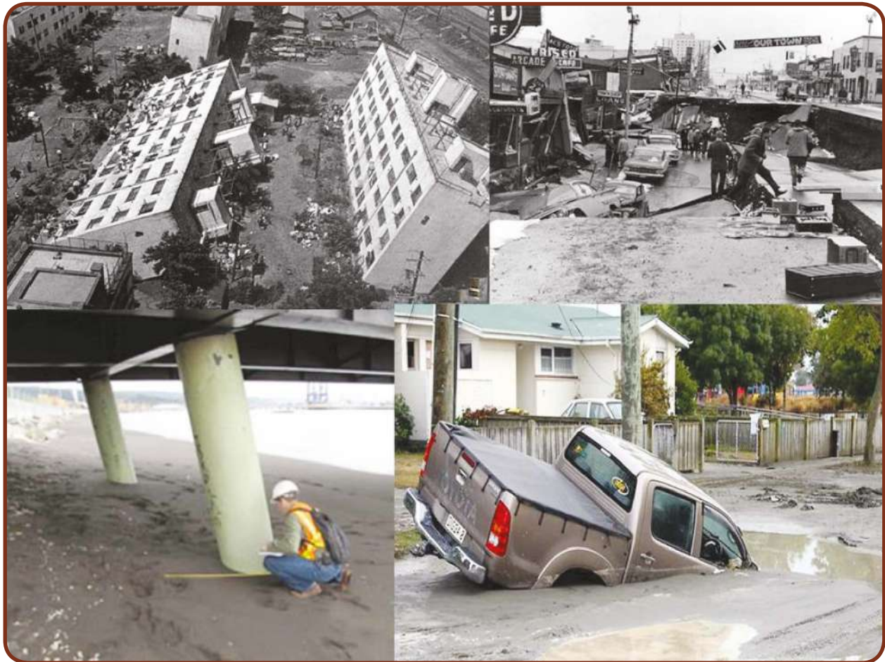
الضرر الناجم عن التسييل لوحظ في (أ) نيفاتا ، اليابان 1964 (ب) ألاسكا ، الولايات المتحدة الأمريكية 1964 (ج) مولي ، تشيلي 2010 و (د) كرايستشيرش ، نيوزيلندا 2010
