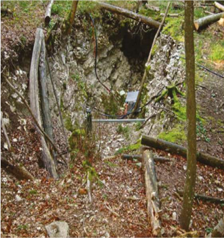
نظام الإنذار المبكر في انهيار أرضي وينكلغرات Winkelgrat مجهز بمقاييس تمدد أوتوماتيكية (يسار) وإشارة مرور لإغلاق الطريق (يمين).
