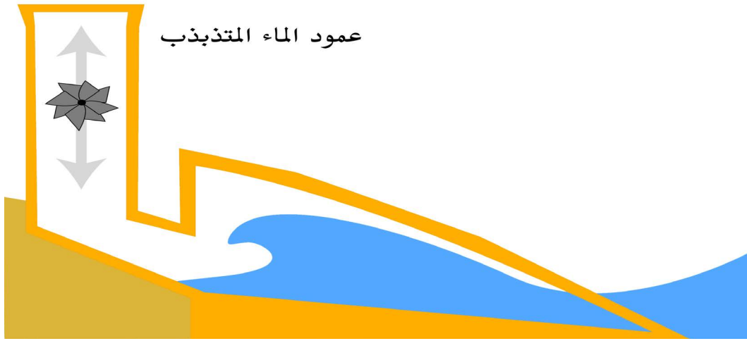
رسم تخطيطي لنظام عمود الماء المتذبذب.
