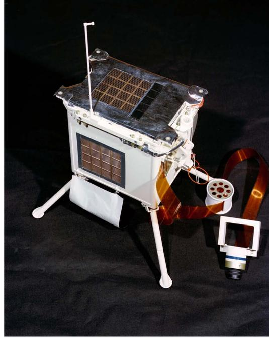
جهاز تجربة القذف القمري والنيازك (LEAM)، هي إحدى تجارب بعثات أبولو على سطح القمر التي نفذتها بعثة أبولو 17- بعد الهبوط في نوفمبر 1972. الغرض من هذه التجربة هو قياس المعاملات الفيزيائية للجسيمات الأولية والثانوية التي تؤثر في سطح القمر.
