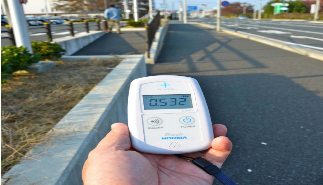
عداد وميض حديث محمول يقرأ جرعة غاما المحيطة. يتم عرض موضع الكاشف الداخلي بواسطة التقاطع.
