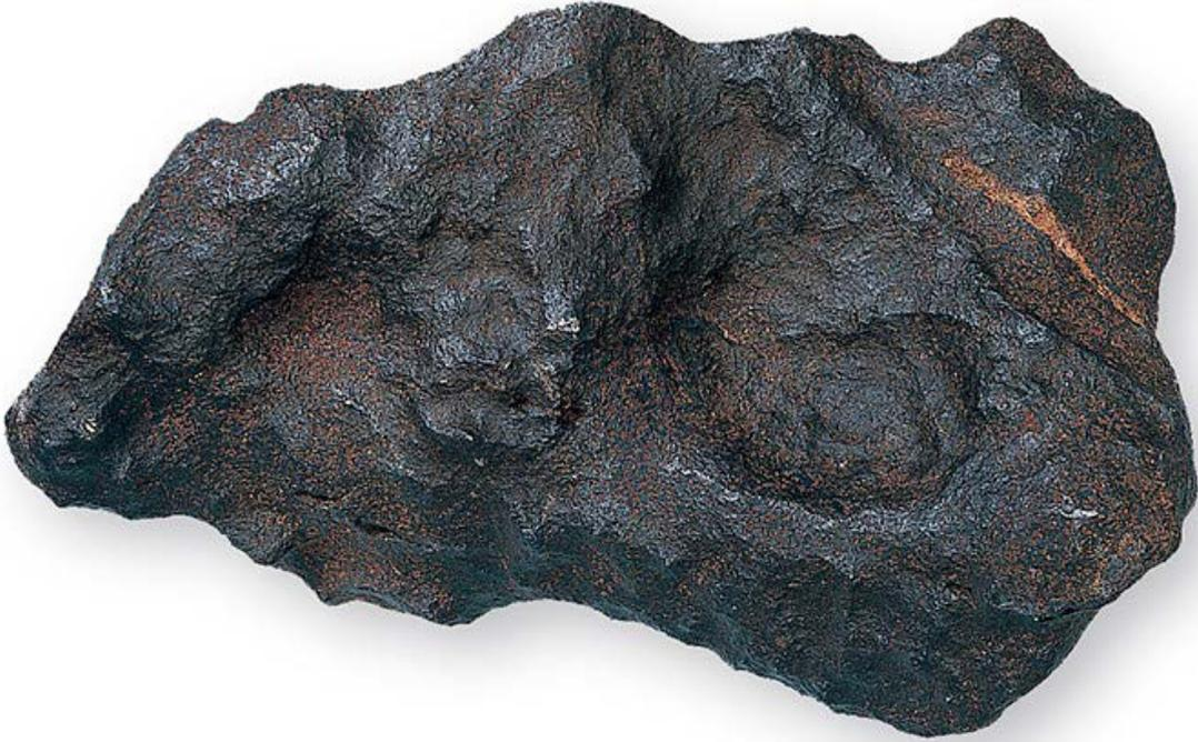
عينة نيزك حديدي تتكون أساساً من معدن الحديد والنيكل وكميات قليلة من الكبريتيد
