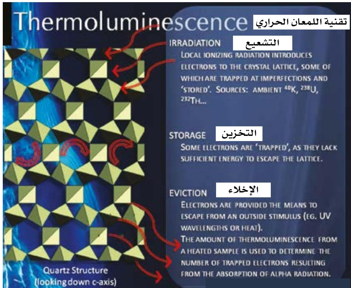
يوضح الرسم البياني تفاصيل تقنية **التلألؤ الحراري**, ويظهر الإلكترونات المحاصرة.
