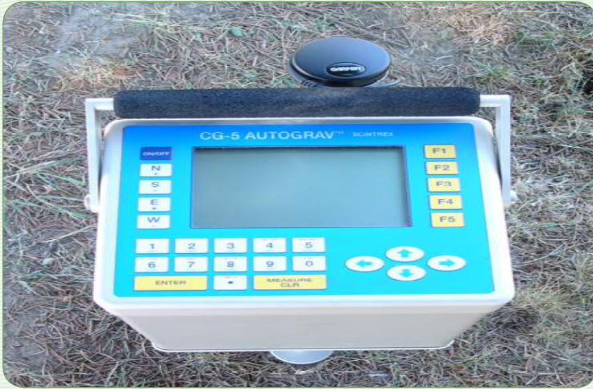
جهاز حديث (الجرافيميتتر) يستخدم لقياس الجاذبية الأرضية من نوع CG-5
